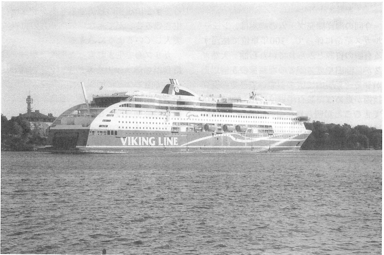
バルト海横断航路に就航する6万総トン型LNG燃料クルーズフェリー「バイキング・グレース」
